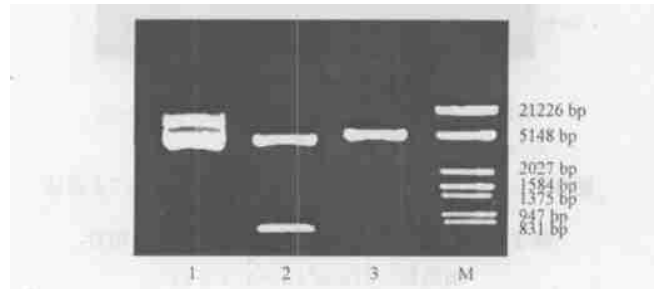
1: 质粒 SFFV. bcl-xL; 2: EcoRI 酶切后 771 bp 和 4.3 kb 两个片段; 3: PstI 酶切后线性化片段; M: marker
